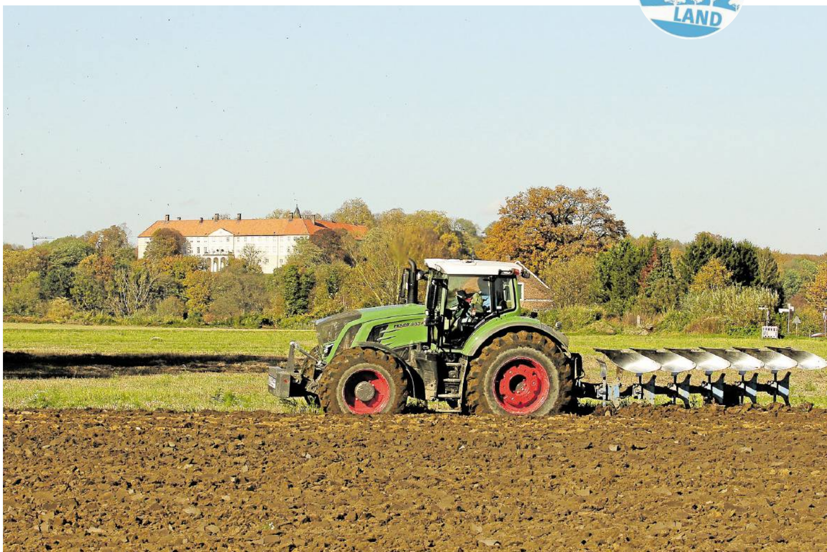
Sechs Schare hat dieser Pflug. Damit wird der Boden gewendet und gelockert.
