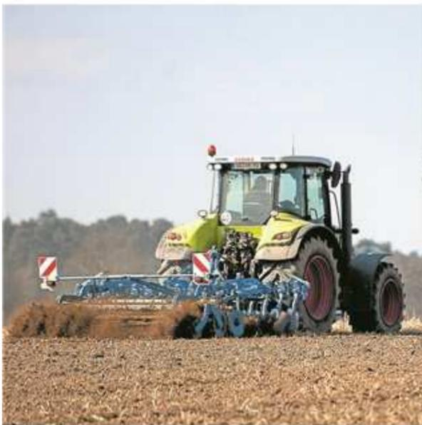
Das ist ein Traktor mit Grubber. Die Zinken des Grubbers graben sich in die Erde.
